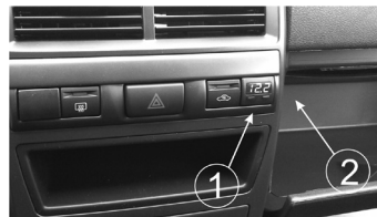
Рис.6 Вид установленного БК
